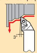
Исполнение режущей кромки **J**
